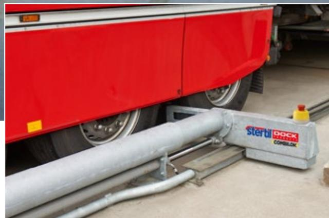
Dank geringer Höhe des Radkeils keine Beschädigung von Schmutzfängern oder Seitenschutzblechen.
